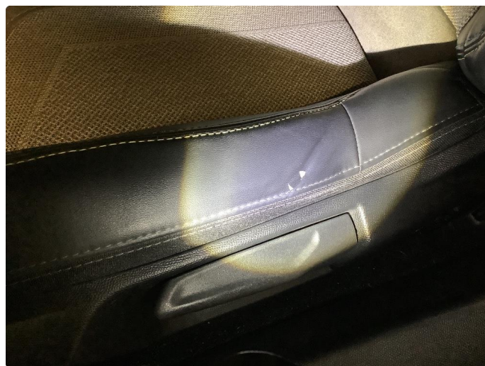
2.1 Skade på setetrekk
