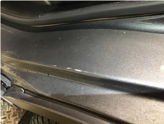
1.2 Noe små bulker i døråpning
