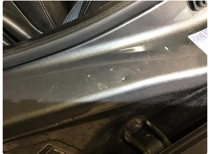
1.2 Noe små bulker i døråpning
