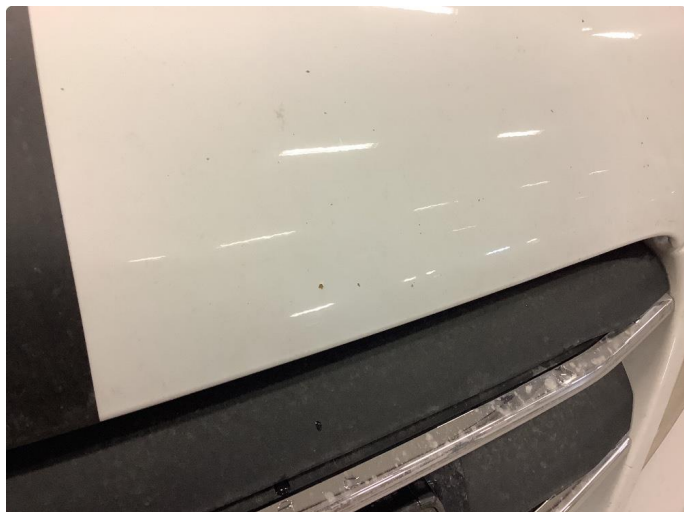
1.2 Noe steinsprut med rust
