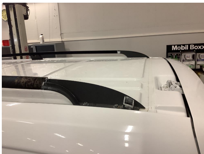
1.5 Deksler på tak/rails mangler
