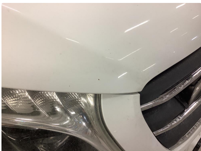
1.2 Noe steinsprut med rust
