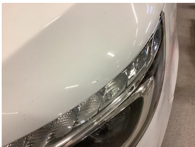
1.2 Noe steinsprut med rust
