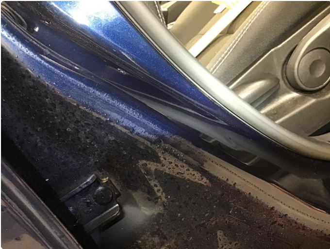
1.2 Noen små bulker i innsteg
