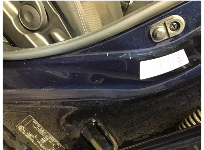
1.2 Noen små bulker i innsteg
