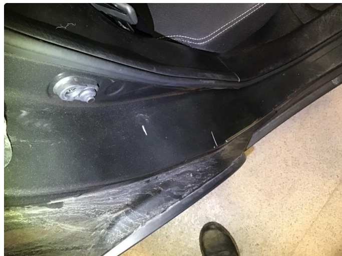
1.1 Små bulk(er) med lakkskade i dørinnsteg
