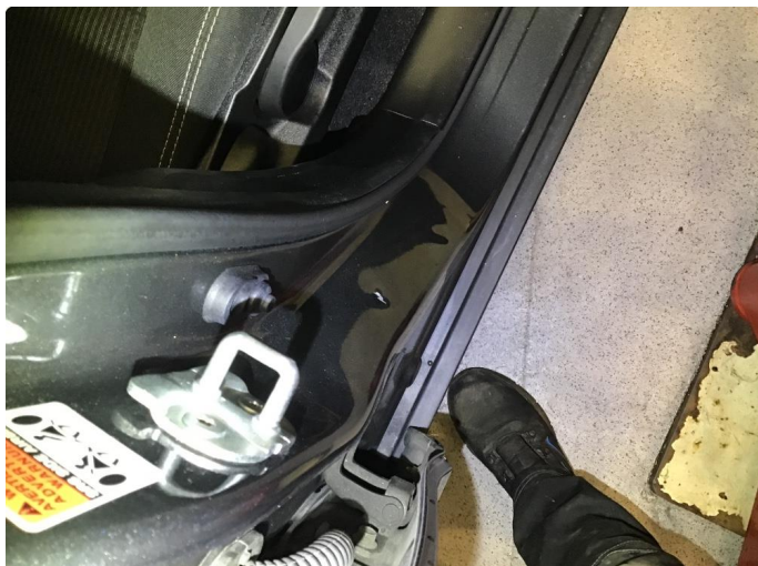
1.1 Små bulk(er) med lakkskade i dørinnsteg
