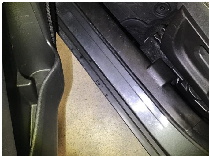
1.1 Små bulk(er) med lakkskade i dørinnsteg
