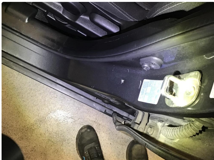
1.1 Små bulk(er) med lakkskade i dørinnsteg
