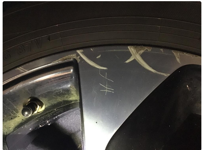
1.2 Noen riper på sommerfelger. , det er ripet inn posisjoner av hs og vs rett på felger.
