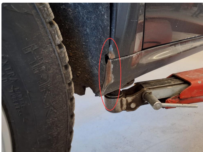
1.4 Noe korrosjon/rust på Kanal, begge sider foran
