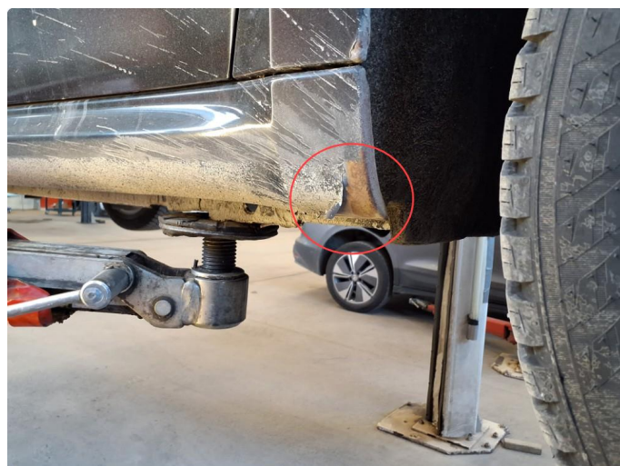
1.4 Noe korrosjon/rust på Kanal, begge sider foran
