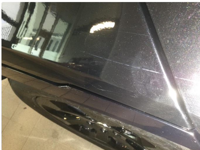
1.6 Ripe(r) ned til grunning
