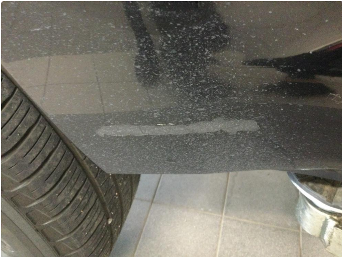
1.3 Ripe ned til grunning
