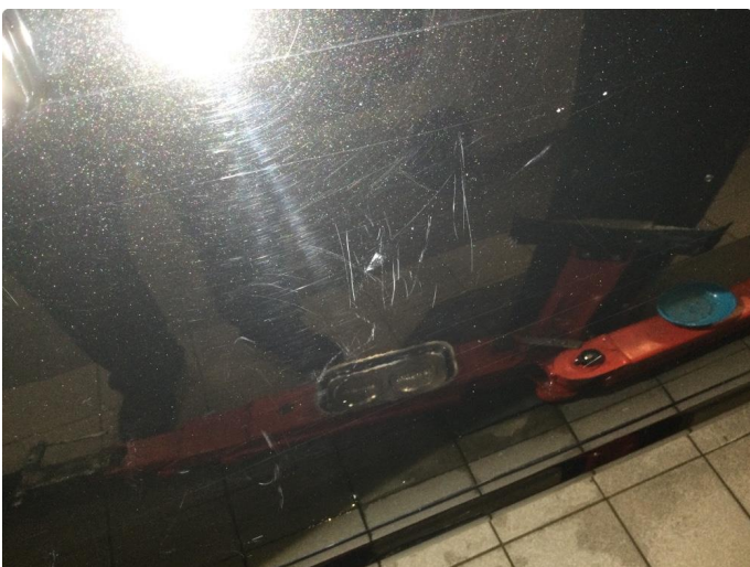
1.4 Ripe ned til grunning
