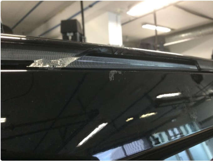
2.1 Defekt / sprukket glass
