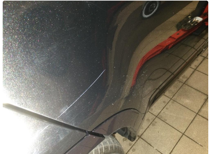
1.3 Ripe ned til grunning
