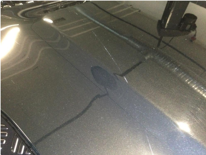
1.2 Ripe(r) ned til grunning
