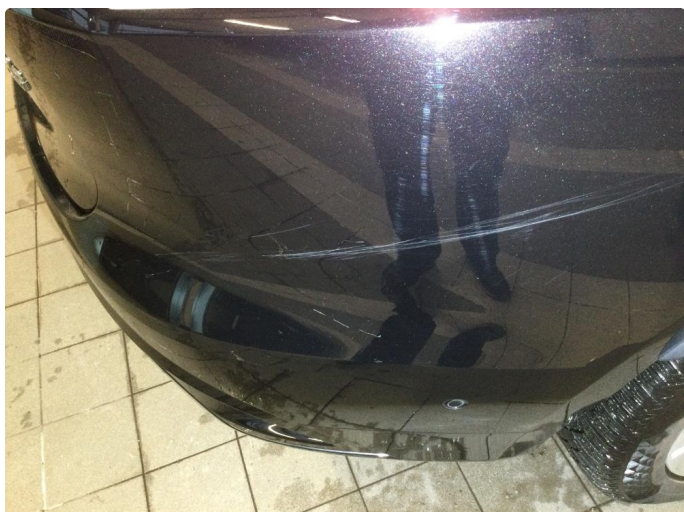
1.2 Ripe(r) ned til grunning
