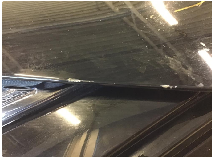
1.1 Bruksslitasje (Rubbet delvis bort) Bruksslitasje
