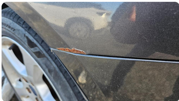
2.5 Rust Rustskader på begge bakskjermer, ved der bakganger festes i hjulbuen. Begge sider bak.
