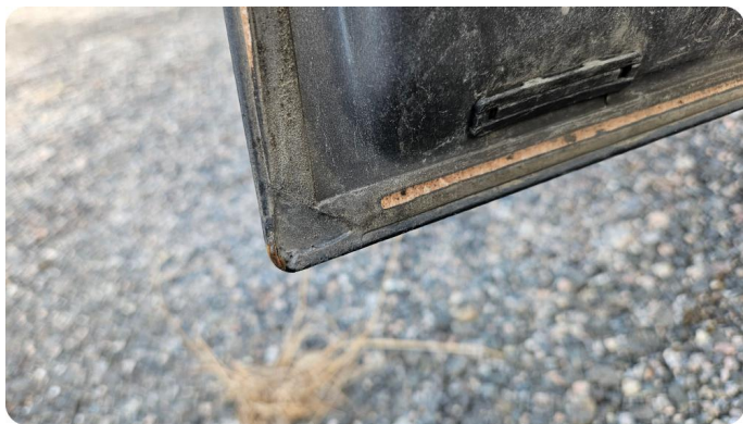
2.4 Rust/korrosjon Skade/rust i alle 4 dører
