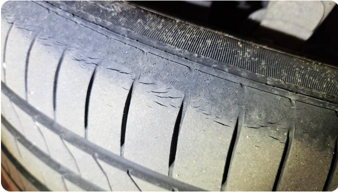
2.11 Dekkskade sommerhjul Alle 4 dekk har begynt å sprekke opp på innsiden - venstre foran er også dekk innsiden veldig skeivslitt - trolig pga karosseriskaden på samme side foran
