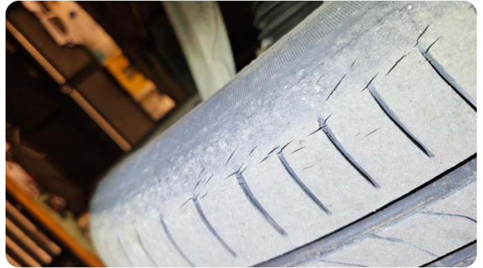
2.11 Dekkskade sommerhjul Alle 4 dekk har begynt å sprekke opp på innsiden - venstre foran er også dekk innsiden veldig skeivslitt - trolig pga karosseriskaden på samme side foran
