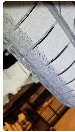
2.11 Dekkskade sommerhjul Alle 4 dekk har begynt å sprekke opp på innsiden - venstre foran er også dekk innsiden veldig skeivslitt - trolig pga karosseriskaden på samme side foran
