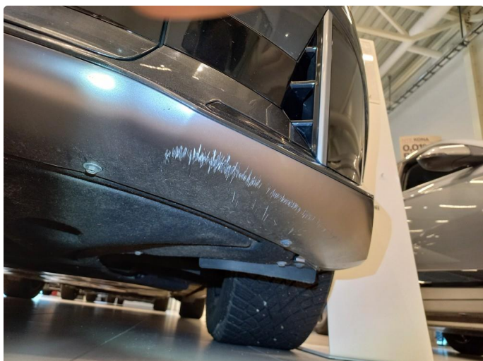
1.1 Ripe(r) ned til grunning - Normal Bruksslitasje
