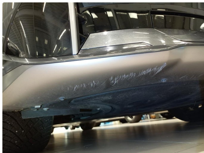
1.1 Ripe(r) ned til grunning - Normal Bruksslitasje
