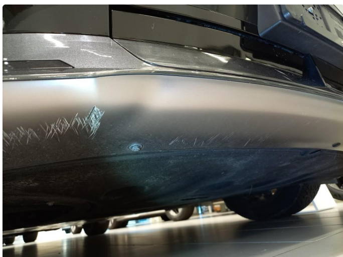
1.1 Ripe(r) ned til grunning - Normal Bruksslitasje
