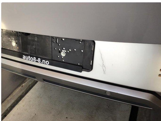
1.2 Ripe bakfanger v/skilt - bruks slitasje
