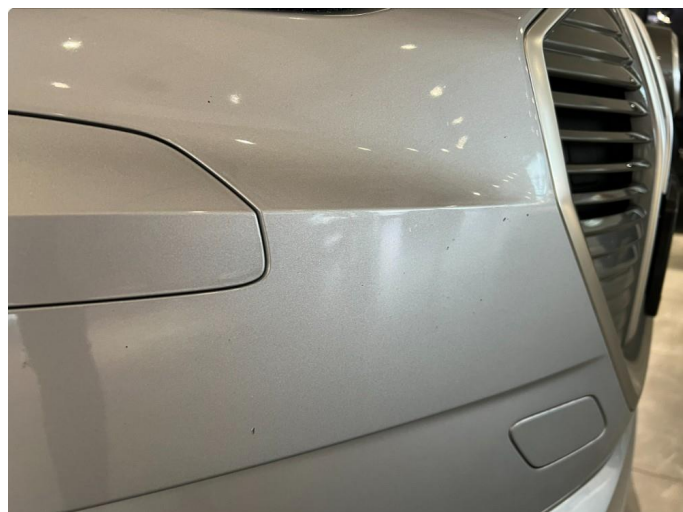
1.1 Stensprut høyre frontfanger
