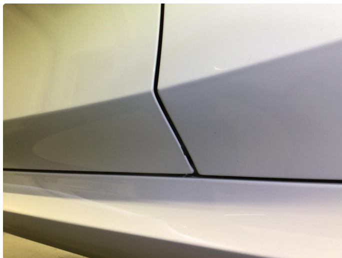
1.2 Rust/korrosjon i nedre kant av dør, i bakkant.
