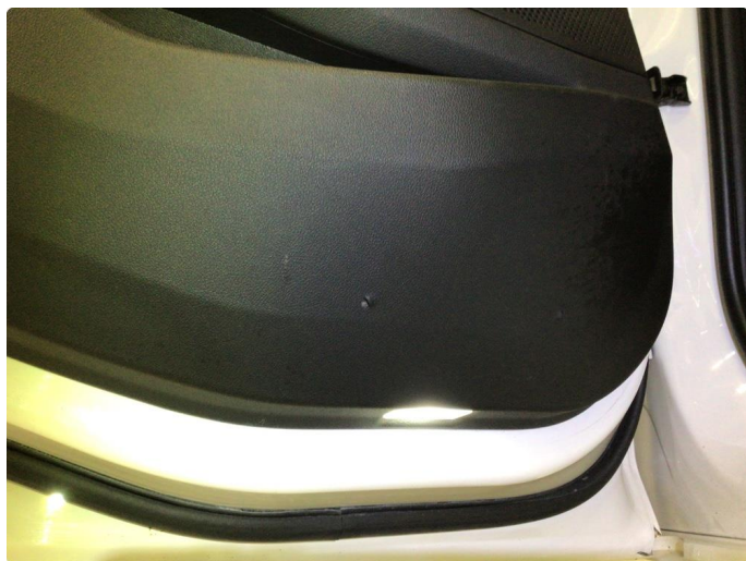
2.2 Skader/slitasje på dørtrekk venstre side bak.
