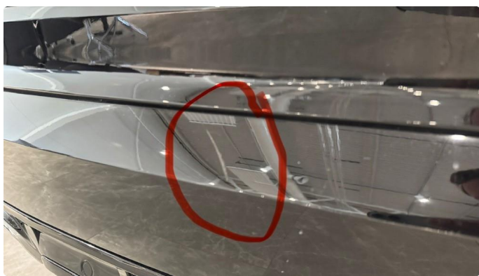
1.5 Ripe i bakfanger og riper i innlastingszone bakluke
