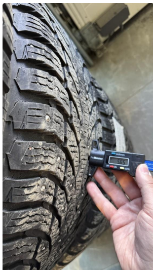
1.4 Noen tørrsprekker i dekk. God mønsterdybde igjen
