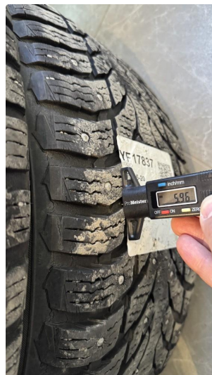
1.4 Noen tørrsprekker i dekk. God mønsterdybde igjen
