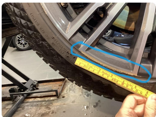
1.4 Vinterfelger kant kjørt
