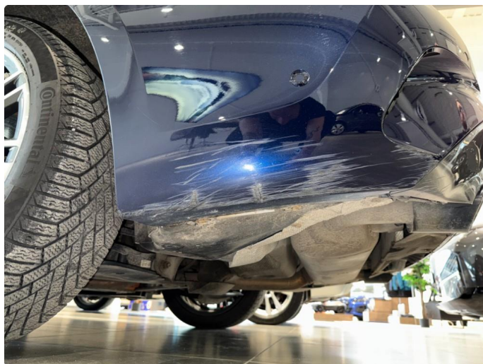
1.2 Skade under støtfanger venstre side bak
