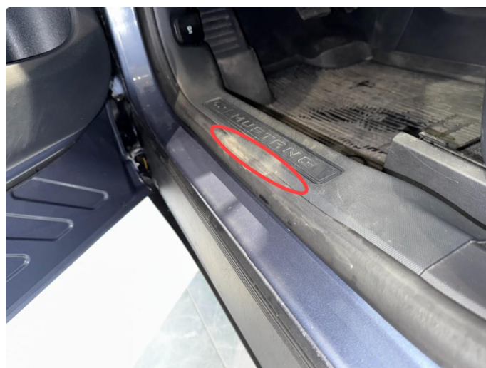
1.6 Foring slitt førerdør
