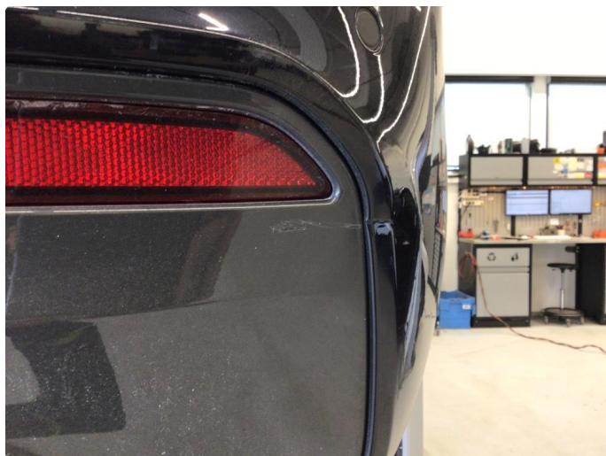
1.3 Ripe(r) ned til grunning
