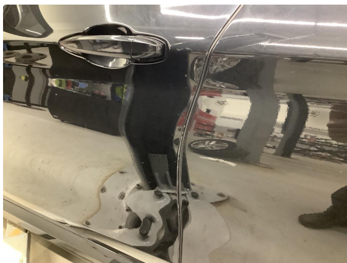
1.3 Lakk flasser i kant av dør
