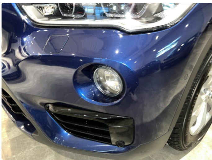
1.10 En del stensprang begge sider av frontfanger
