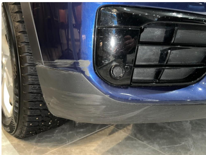
1.11 Skrape merker/riper ned til grunning etter parkeringskade.
