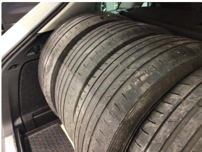
1.8 For lite mønsterdybde sommerdekk premium - byttes før videresalg
