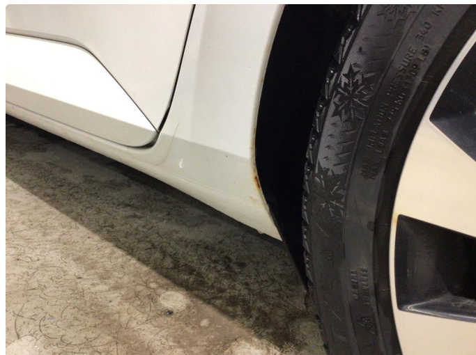
1.3 På skjerm - pusses og lakkeres før videresalg
