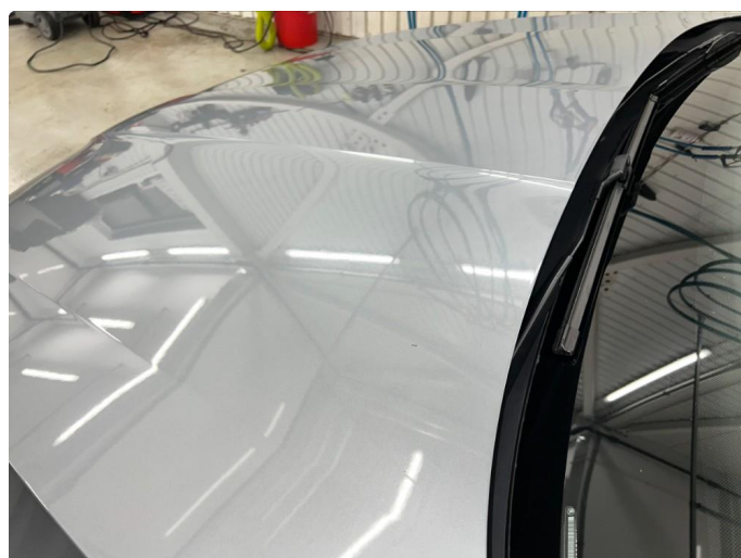
1.2 Stensprut og sår/riper rundt om på panser. Normalt for år/km.
