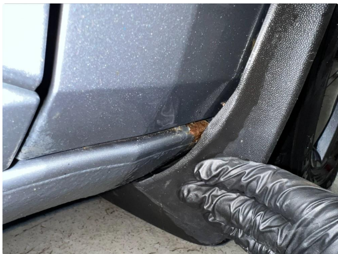
1.4 Rust. Utbedres og flekk lakkeres før videresalg.
