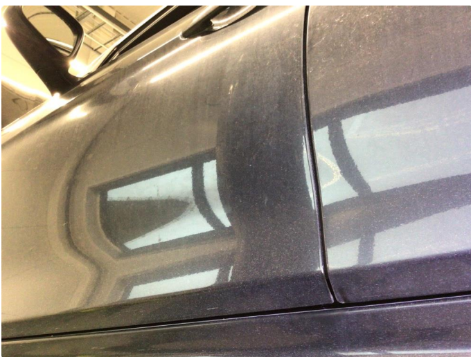
1.3 Rust i fals - pusset og flekk lakket
