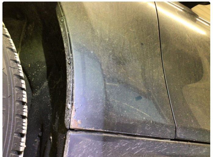
1.5 Rust - pusset og flekk lakket
