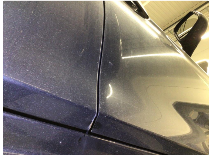
1.3 Rust i fals - pusset og flekk lakket
