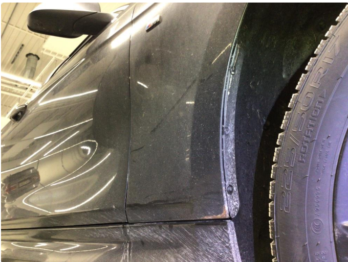
1.5 Rust - pusset og flekk lakket
