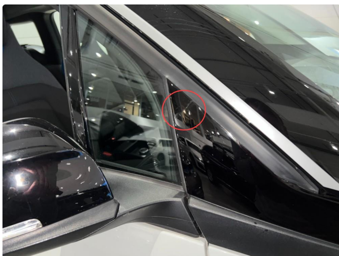
1.4 Sprekk/krakelering på pyntelist høyre side foran.
