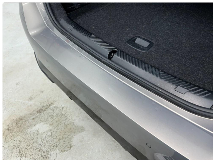
1.1 Mindre sår/riper ved innlastningssone bagasjerom, bedre en normalt for år/km.
