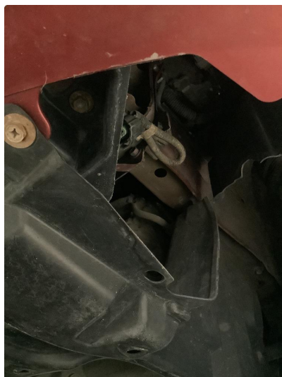
1.5 Plast innerskjerm foran på begge sider skadet/mangler
