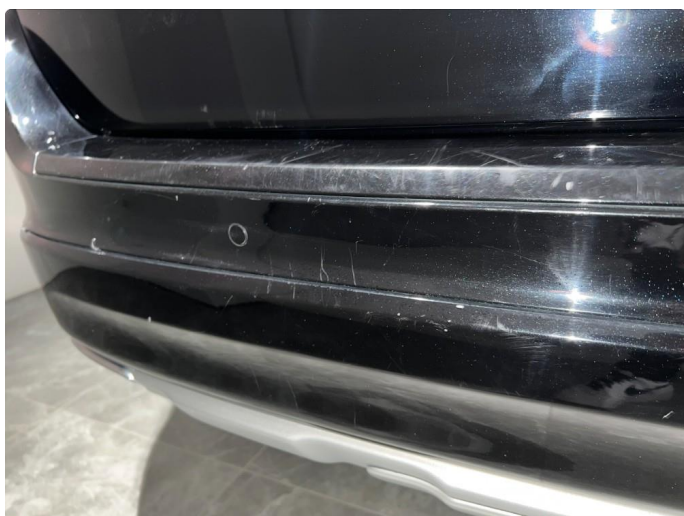
1.10 Skrubbsår/hakk i bak fanger.
