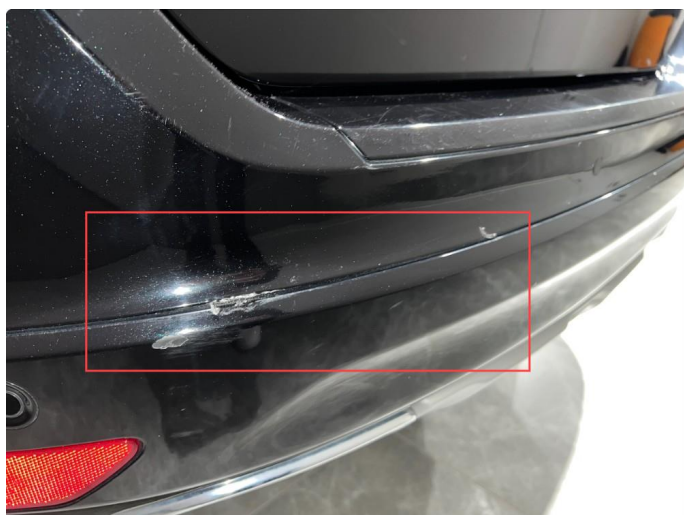
1.10 Skrubbsår/hakk i bak fanger.
