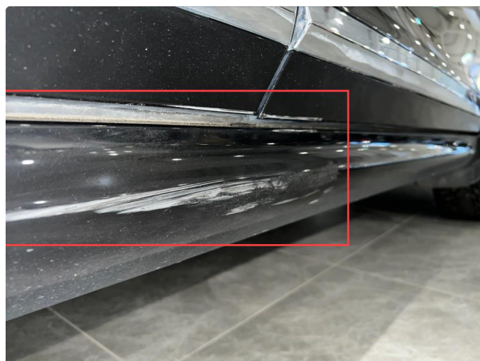
1.2 Riper ned til grunning.
