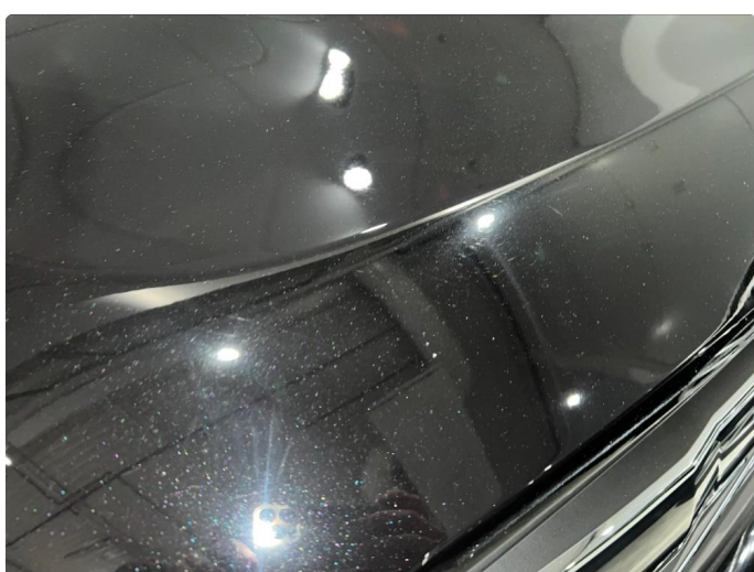
1.3 En del stensprang og riper rundt om på panser
