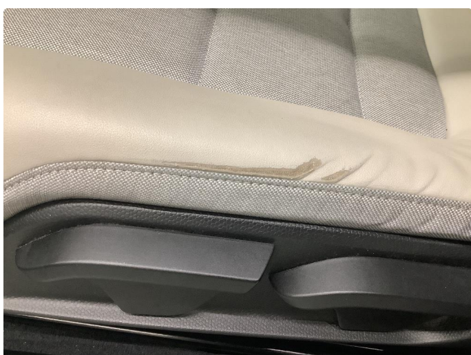
2.1 Slitasje på førersetet, normalt med tanke på år/km.
