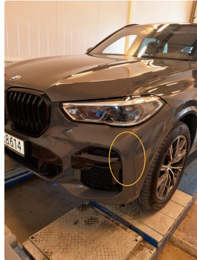
1.2 Liten steinsprut på fram fanger ubetydelig.
