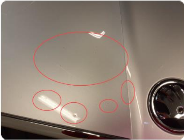
2.2 Bulk med lakkskade + mye steinsprut
