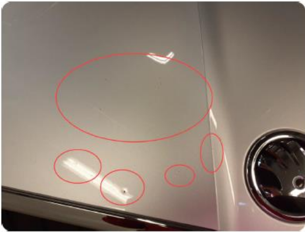
2.2 Bulk med lakkskade + mye steinsprut
