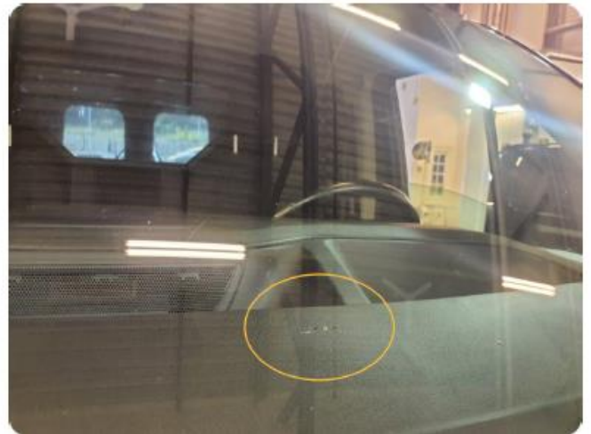
1.3 Steinsprut med sprekk
