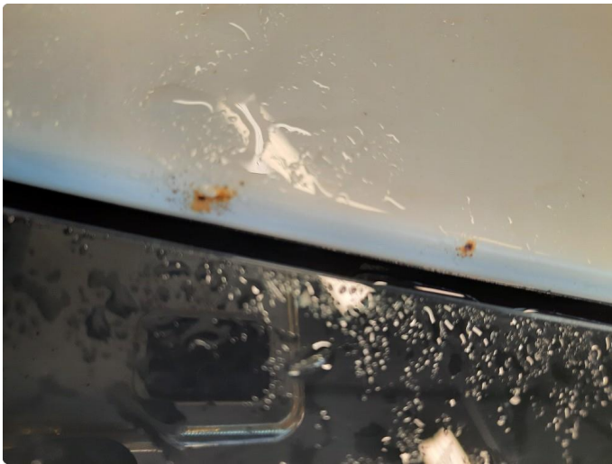
1.1 Steinsprut med rust
