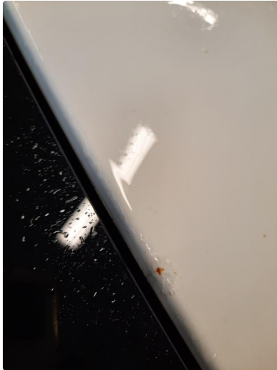
1.1 Steinsprut med rust
