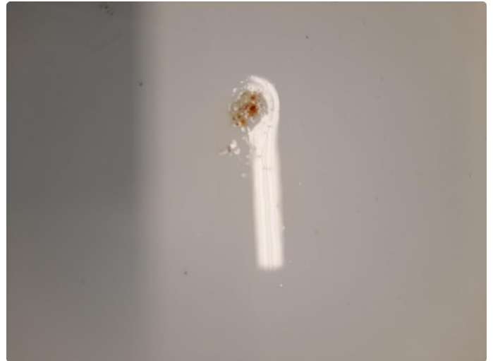
1.1 Steinsprut med rust
