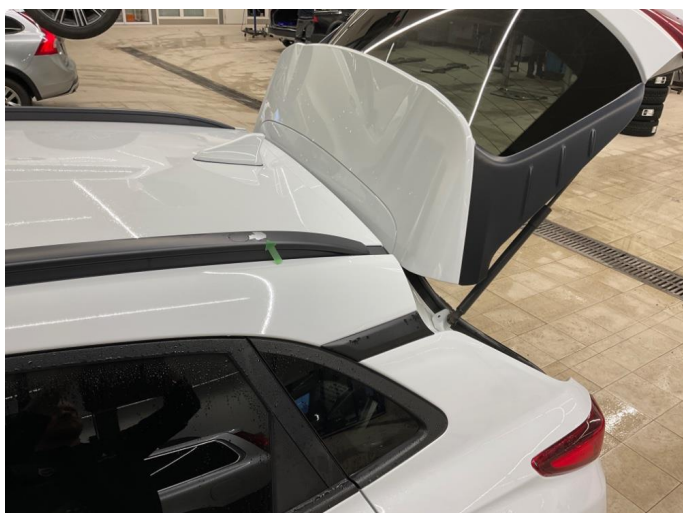
1.2 Deksler på tak/rails mangler
