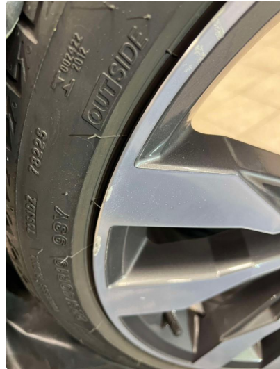
1.1 Kantkjørt felg Diamond Cut
