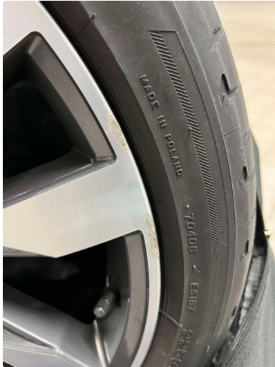
1.1 Kantkjørt felg Diamond Cut
