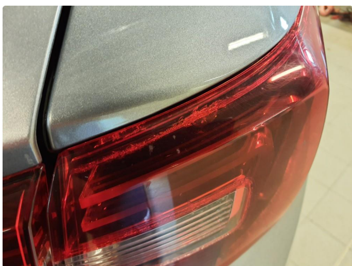
2.3 Krakelering i plast
