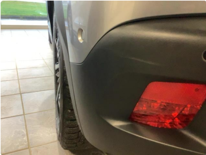
1.1 Riper i plastikk. Støtfanger v.s bak
