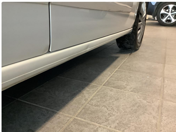
1.6 Skade på begge kanaler
