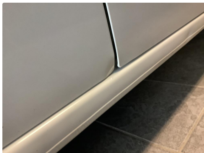
1.3 Bulk på høyre skyvedør
