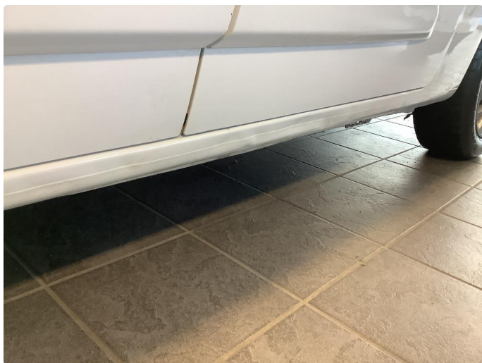
1.6 Skade på begge kanaler
