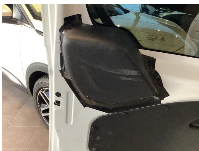
1.5 Skadet deksel til pussers motor bak
