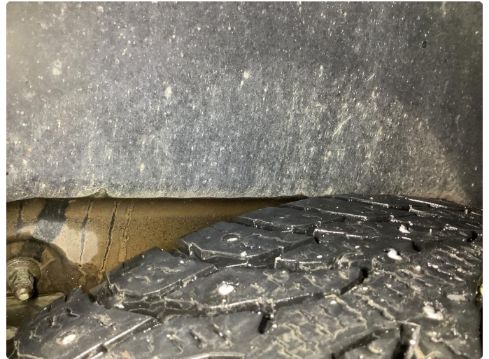
1.2 Piggdekk mangler pigger
