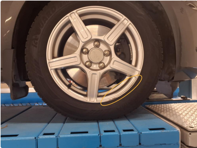
1.1 Noe små skade på felg
