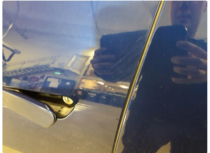
1.1 Noen riper og steinsprut
