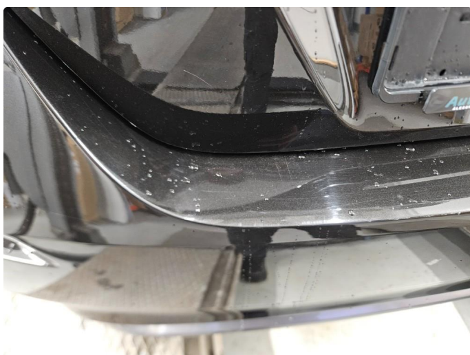
1.1 Noen riper og småbulker
