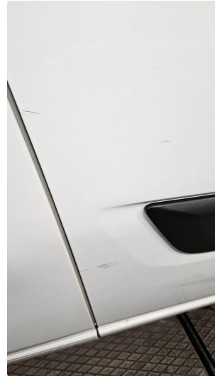
1.1 Generelt noe riper og småbulker
