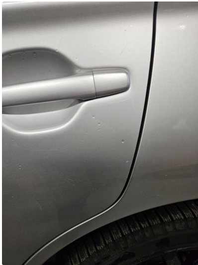
1.1 Noen riper og småbulker
