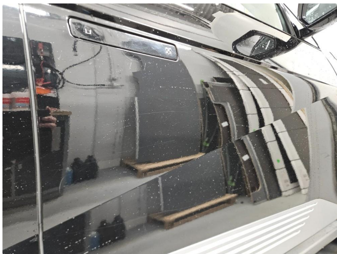
1.1 Noen riper og småbulker
