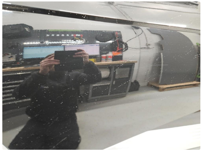
1.1 Noen riper og småbulker
