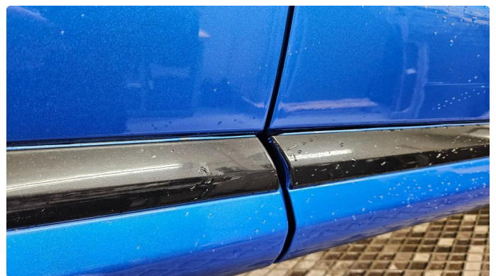
1.1 Noe riper og småbulker
