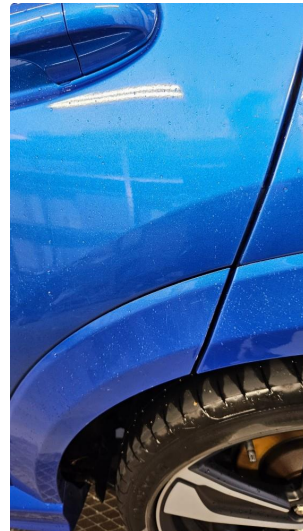
1.1 Noe riper og småbulker
