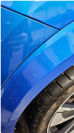
1.1 Noe riper og småbulker
