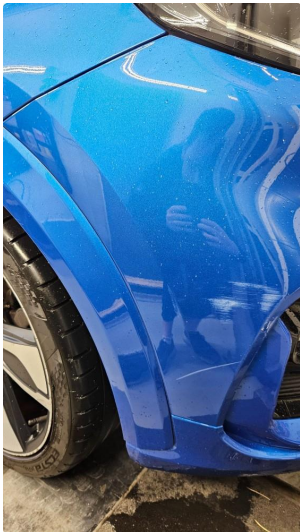
1.1 Noe riper og småbulker
