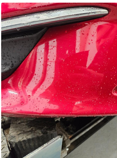
1.1 Noen riper og småbulker
