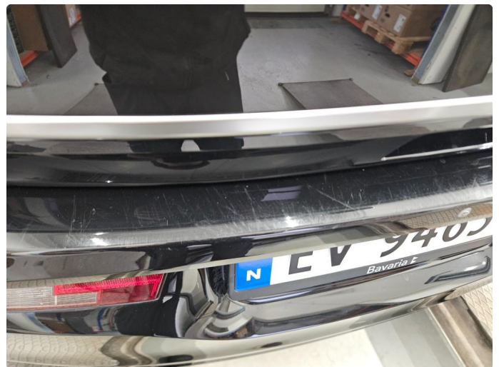
1.1 Noen riper og småbulker
