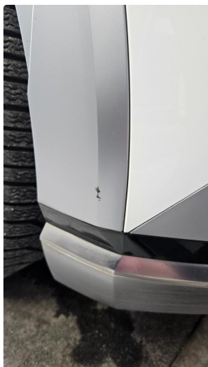
1.1 Noen små stensprut
