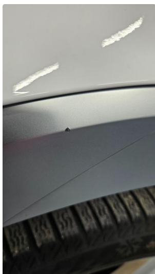
1.1 Noen små stensprut
