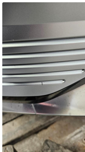
1.1 Noen små stensprut
