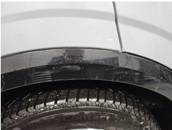
1.1 Noen småriper, dette er stort sett fjernet ved polering.
