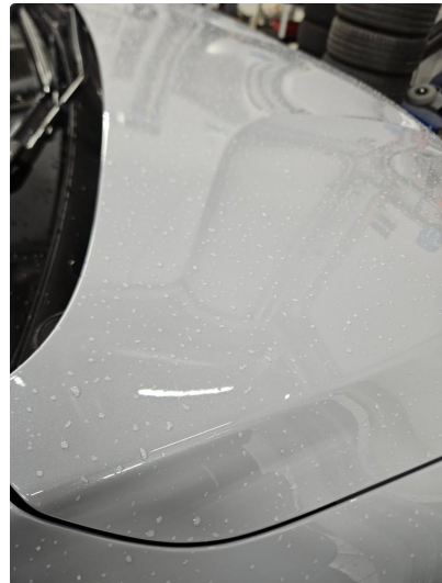
1.1 Noen småriper, dette er stort sett fjernet ved polering.
